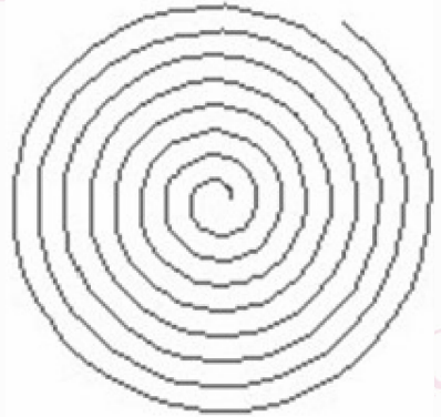
图 4 未经反走样处理的阿基米德螺旋线
